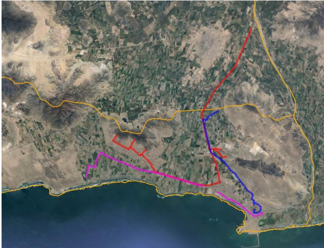
En la figura, se muestra el ámbito que requiere levantamiento topográfico para las líneas proyectadas o a mejorar, de agua potable y alcantarillado, de las posibles alternativas, los trazos son relativos por lo que le corresponde definir al Consultor.
